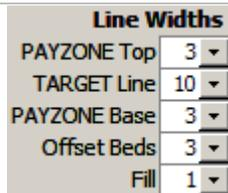
Используйте соответствующий выпадающий список для задания толщины линии в пикселях для кровли продуктивного пласта, целевой линии, подошвы продуктивного пласта, границ отстоящих пластов и линии вертикального заполнения.
